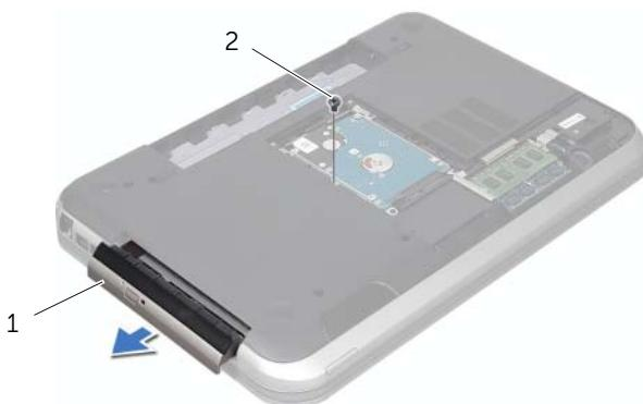
1 sklop optičkog uređaja
